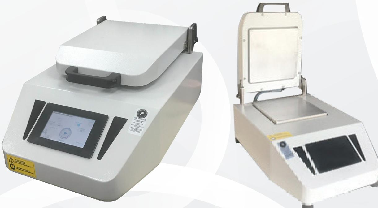
**Ütü Haslığı Test Cihazı** her çeşit ve türdeki tekstil madde ve mamullerinin renklerinin ütulemeye ve sıcak silindirler arasında işlenmeye karşı dayanımının tayini için kullanılır. Cihaz elektronik sıcaklık kontrollüdür. Üst plaka ağırlıkları ilgili standartlara göre düzenlenmiştir. Ayarlanabilir Sıcaklık Aralığı: 20...230 °C dir. 102x29 mm. Tek plakalı 125x125 mm. Tek plakalı 102x29 mm. Beş plakalı modelleri mevcuttur
